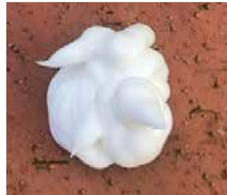
KÖSTER Crisin Creme ist standfest. Für die Anwendung aus Kartuschen und Schlauchbeuteln ist dies ein Verarbeitungsvorteil: Selbst wenn zu viel Produkt in ein Bohrloch dosiert wird, entstehen nicht gleich ablaufende „Nasen“ am Putz, die nachträglich zu dunklen Stellen führen. Das überschüssige Material kann entfernt und das Bohrloch anschließend verputzt werden.
